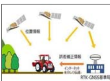
農業機械の自動走行に必要なRTK-GNSS基準局の設置 ※位置情報を補正し自動操舵の走行誤差を2-3cmに抑制するもの
